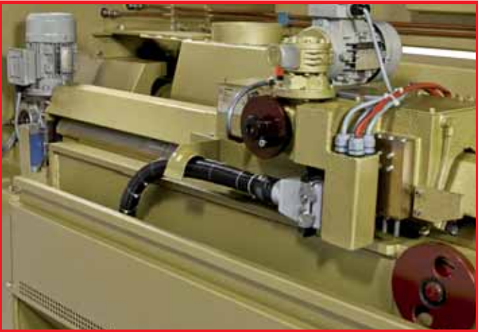
Carrello affilatore, in ghisa speciale trattata termicamente, con corsa su guide prismatiche. Lubrificazione permanente garantita da una speciale pompa con segnale di olio esaurito. Grinding carriage, made by heat-treated special cast iron, placed upon prismatic rails. A special pump maintains a permanent lubrication with oil-empty signal.
