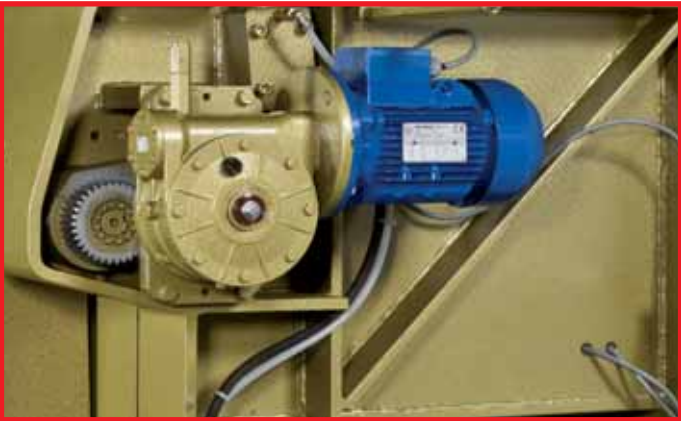
Trasporto sul rullo gommato di supporto. Support feed in rubber roller.
