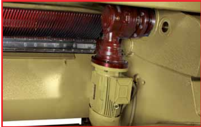
Trasporto di lavoro principale elettrico su rullo cromato a velocità variabile, visualizzata, con rampe di accelerazione e decelerazione. E' possibile avere velocità diverse senza strappi durante la fase di lavoro, imbocco, culatto, testa. Per facilitare l'imbocco e la distenditura delle zampe anteriori si può programmare la partenza del rullo gommato anticipata. Electrical main working transport on chrome roller at variable speed, visualized, with ramps of acceleration and deceleration. It's possible to have different speed without tears during the phase of work, feed-in, back and head. To facilitate the feed-in and stretching of the forelegs, it's possible to program the starting of the rubber roller.
